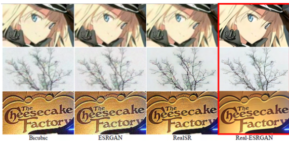
図 5 実際の画像における Bicubic アップサンプリング, ESRGAN[10], RealSR[11], Real-ESRGAN の結果比較. 合成データで訓練された Real-ESRGAN モデルは、一般的な実世界の画像に対し、煩わしいアーティファクトを除去しながら、詳細を強調することが可能である。
