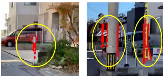
図7 基本アルゴリズムにおいて 死角として誤検出されたエッジ
