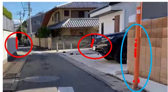
図2 検出すべき死角(赤枠)と除外すべき死角(青枠)
